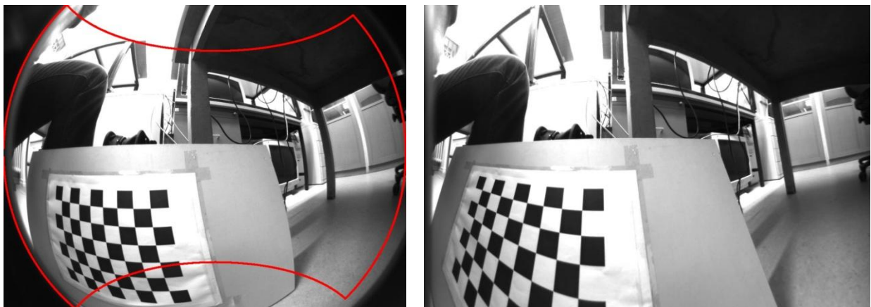
Abbildung 3: Aufnahme eines Bildes mit Fisheye-Optik (links) und entzerrtes/kalibriertes Bild
