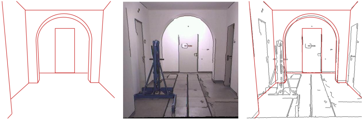
Abbildung 1: Zuordnung (rechts) eines 3D-Modells (links) zu Kanteninformationen (Mitte)
