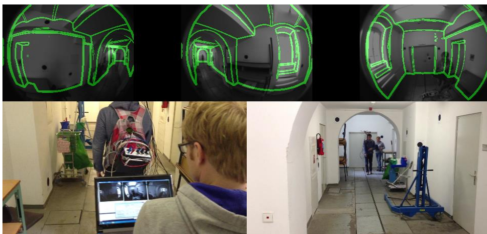
Abb. 7: Einsatz des mobilen Systems und Zuordnung des 3D-Modells zu den Bilddaten
