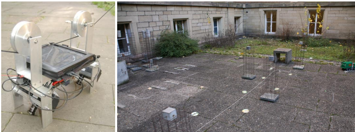
Abb. 29: Sensorplattform (links) wird zur Datenerfassung entlang eines Seiles über die Szene (rechts) bewegt
